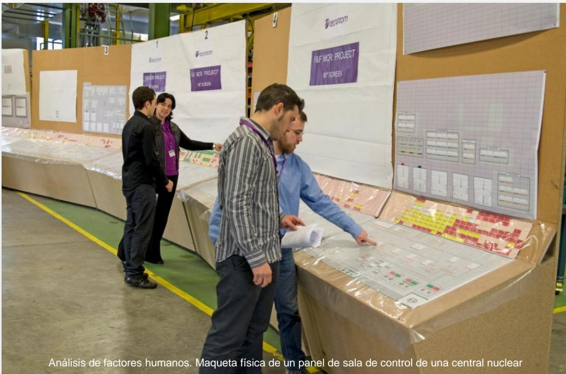
Análisis de factores humanos. Maqueta física de un panel de sala de control de una central nuclear
