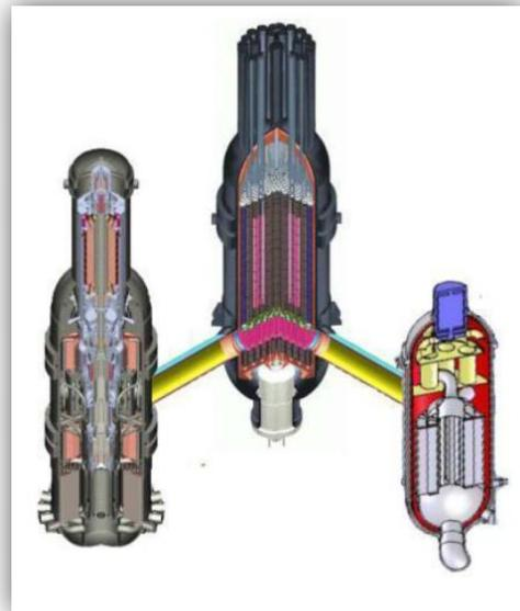
El combustible es TRISO, formado por partículas de  $UO_2$  o  $UOC$  de diámetro inferior a 1 mm. Utiliza el ciclo Brayton directo de conversión de potencia y lazo indirecto para aplicaciones de calor de proceso. La eliminación del calor residual se realiza por medios pasivos. Consta de dos vasijas interconectadas encapsuladas dentro de una estructura de
